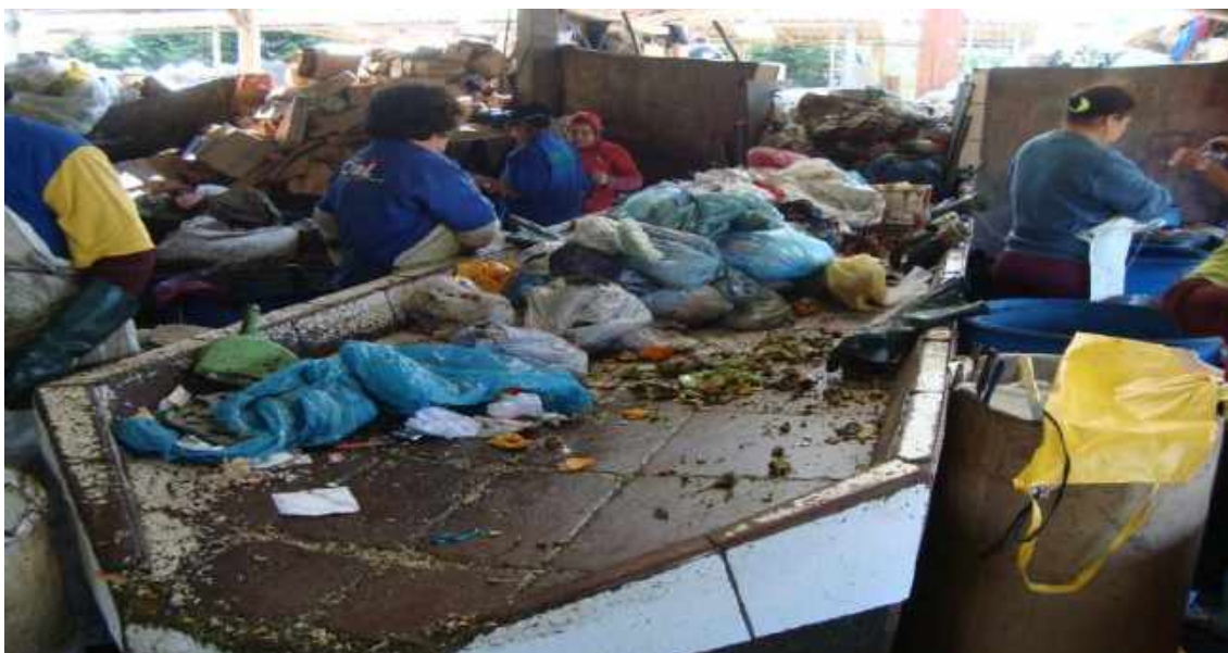
Figura 62 – Vista da esteira de separação onde o lixo seco é separado do lixo úmido orgânico no Galpão de Triagem de Resíduos Sólidos (Unidade de Triagem de Compostagem).
