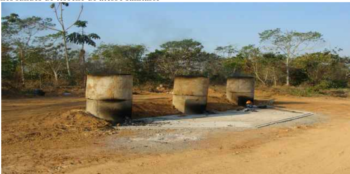
Figura 1 – Vista dos três fornos provisórios de incineração dos resíduos sólidos de saúde nos fundos do terreno do aterro sanitário
