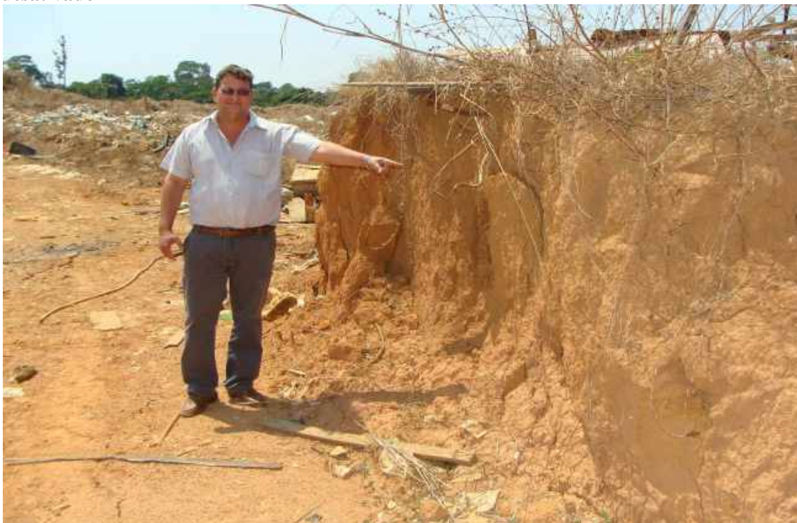
Figura 4 – Vista do perfil de um argissolo, no local de instalação do antigo lixão, ora desativado
