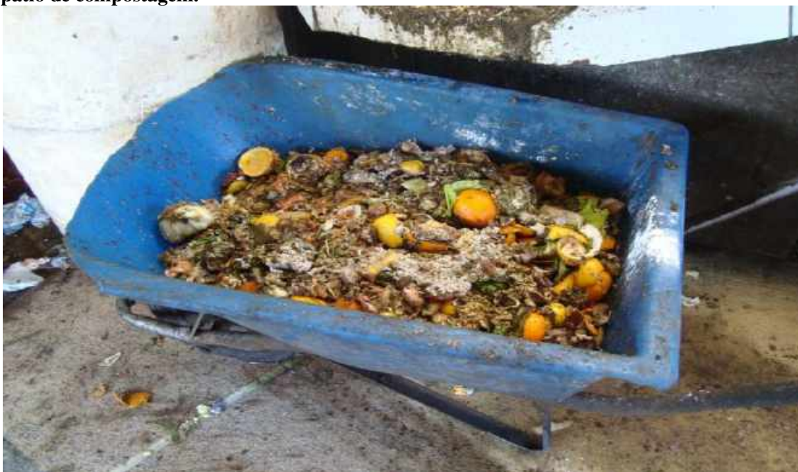
Figura 64 - Detalhe dos resíduos sólidos úmidos orgânicos após serem misturados a palha de arroz ao lado da esteira de reciclagem aguardando para serem dispostos em montes no pátio de compostagem.
