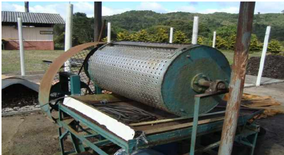
Figura 71 - Foto da peneira que efetua a padronização da granulometria do material.
